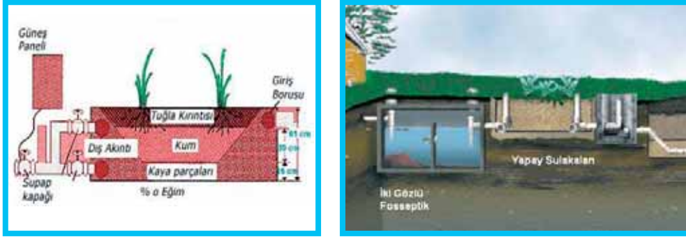
Şekil 4. Ankara-Haymana-Dikilitaş Köyü'ndeki Yapay Sulak Alan Kesiti (ANONİM., 2003).
