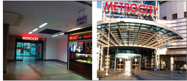
Şekil 7: İstanbul Metrocity AVM metro girişi ve ana girişi: otomatik kapı kullanımı, hissedilebilir yüzey döşemesi kullanımı Kaynak: Fotoğraf, Güliz Muğan, 13.08.2015
